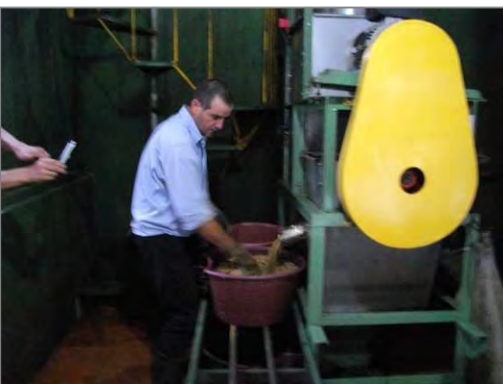
パルパーマシン。剥いた豆は、水がしたたる状態でゴゴに入れて乾燥場に運び広げる。
